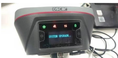
Изображение 11 Обновление прошивки (версии Ultimate и Advanced)
