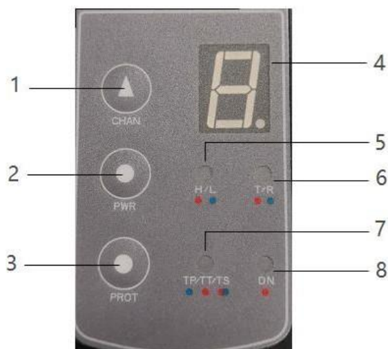
Рисунок 6.21 Передняя панель радиомодема
