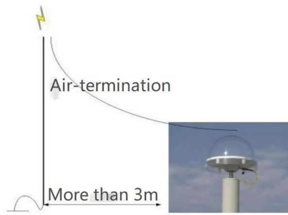
Рисунок 7.1 Описание метода установки молниезащиты
